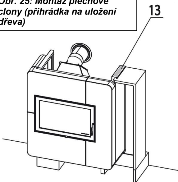
Obr. 26: Montáž pravé boční stěny
