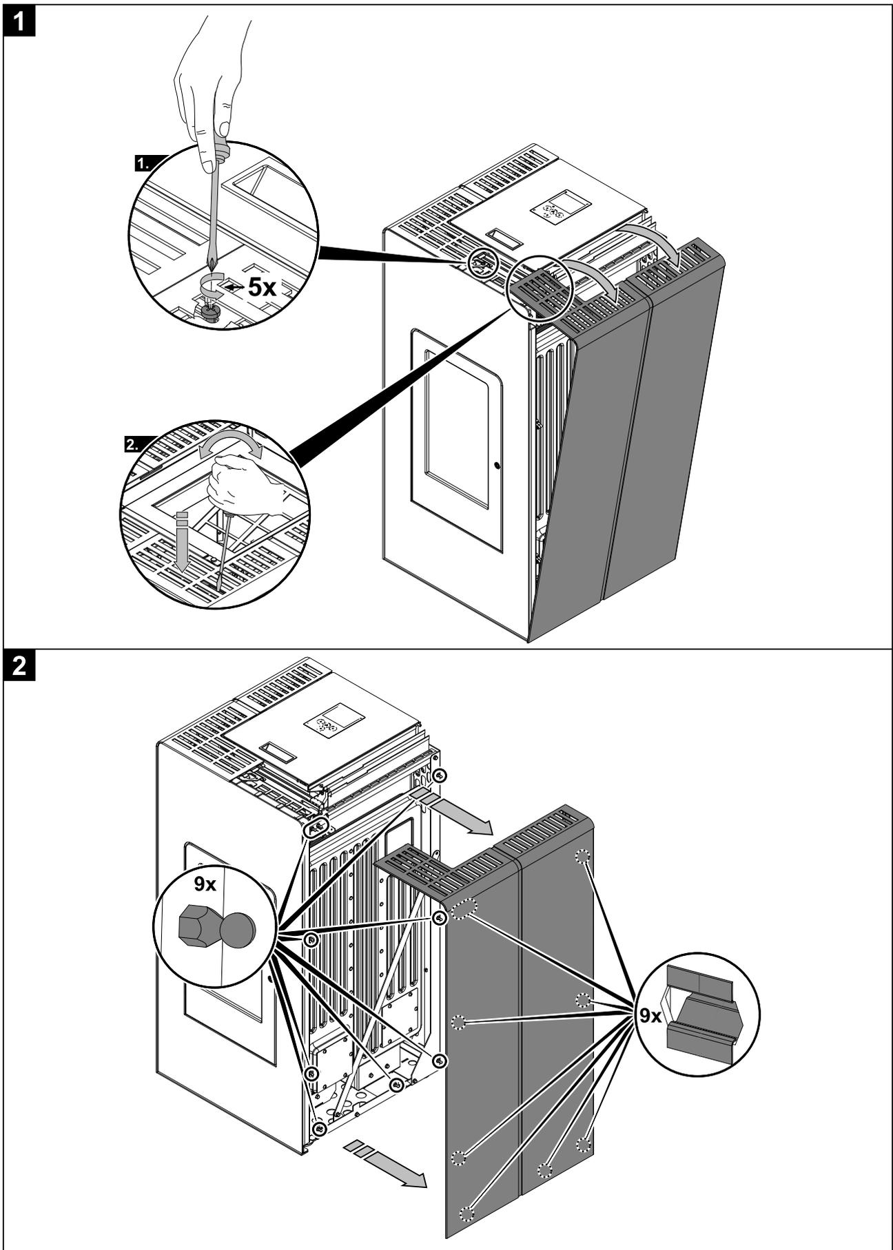
Obrázek 3a: Demontáž boční stěny
