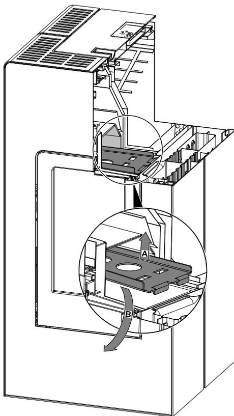
Obrázek 2: Demontáž desky přesměrování tahu
