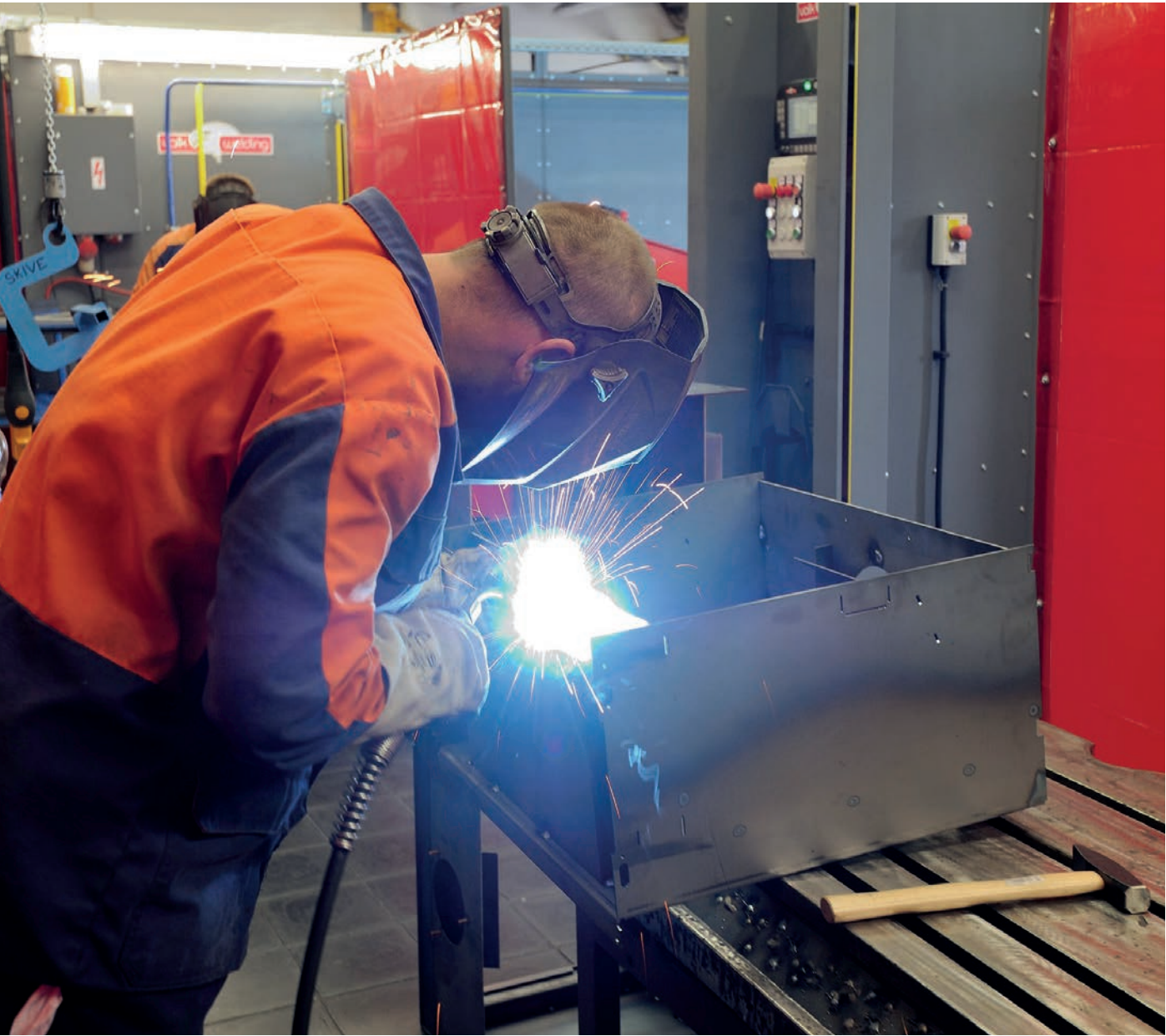
Svařování spalovací komory
